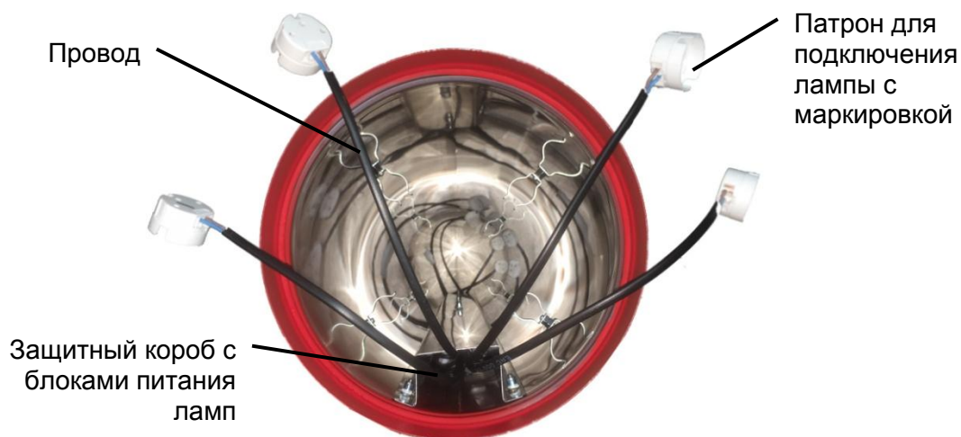
Рис. 6 Подключение ламп к блокам питания (вариант РБУ-155 с 4 лампами)
