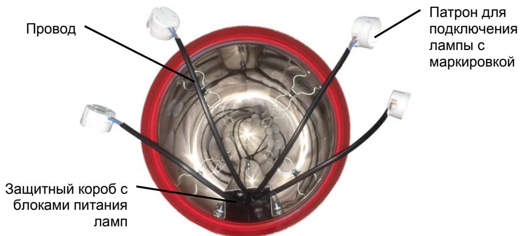
Рис. 6 Подключение ламп к блокам питания (вариант РБУ-155н с 4 лампами)
